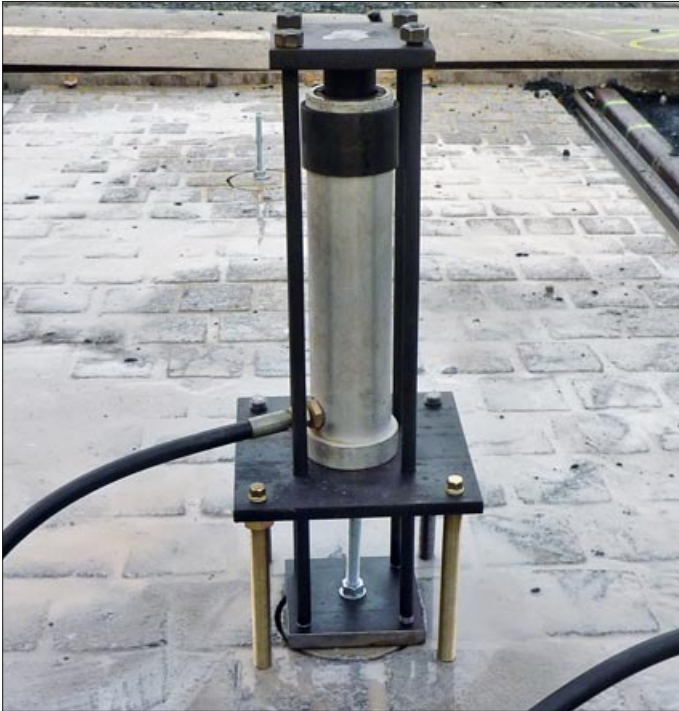
5. Gerät zum Aufbringen und Erfassen der Abreißkraft
