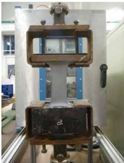
Bild 2: Versuchsvorrichtung mit kaltverarbeitbarem Fugendichtstoff (Bild: DVB AG)
